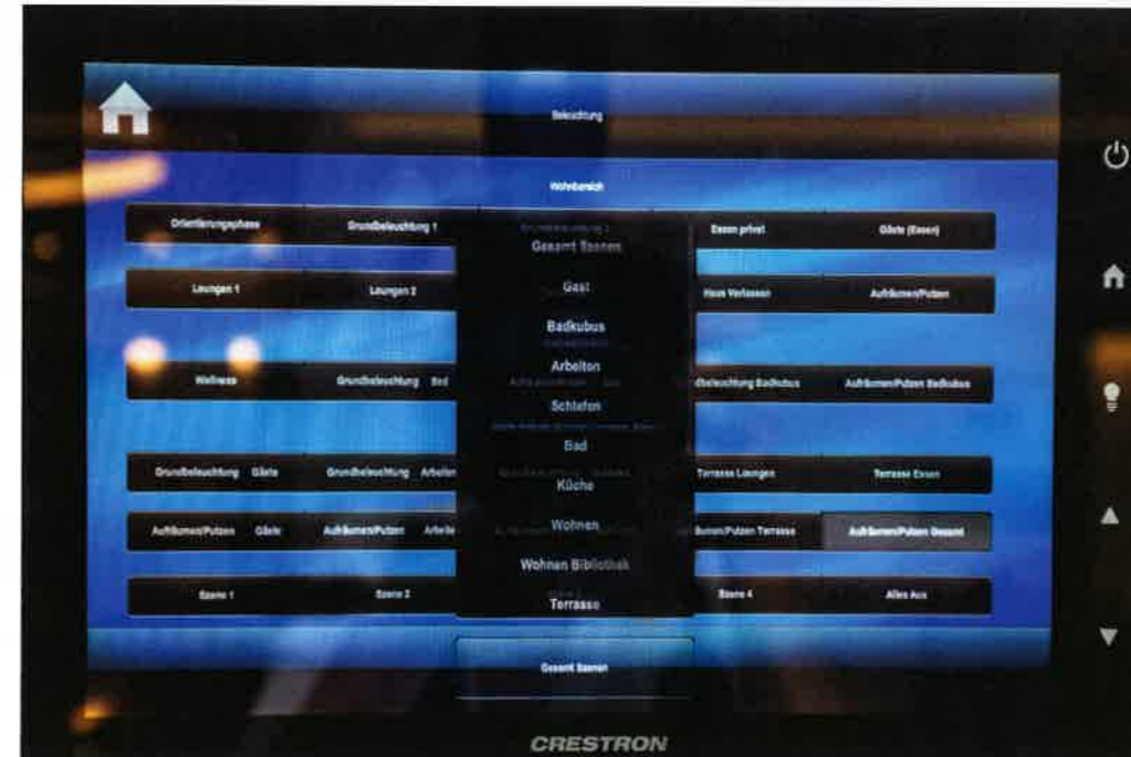
Innovativ, bequem und komfortabel: Zentrale Funktionen in der Loftwohnung wie die Beleuchtung, Alarmanlage, das Audio- und Videosystem, die Jalousien sowie die Heizung steuert das technikaffine Ehepaar über sein Hausautomationsystem.
